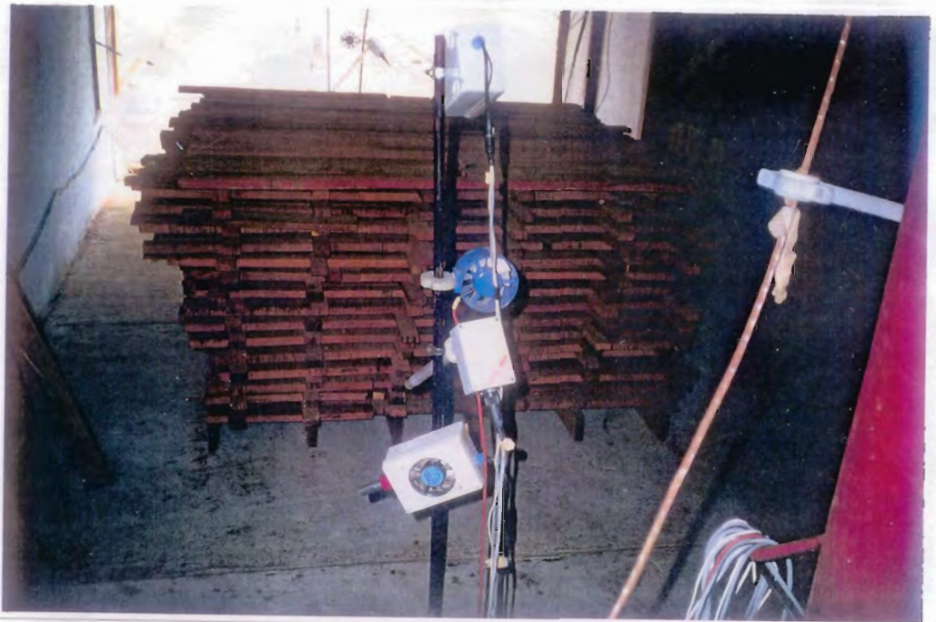
Bild E.7: Solare Holztrocknungsanlage mit natürlicher Konvektion: Blick in die Trocknungskammer während des ersten Trocknungsversuchs; vorne im Bild Meßinstrumente für Lufttemperatur, -feuchte und -geschwindigkeit
