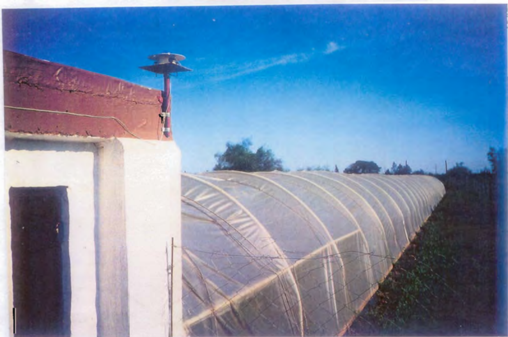
Bild E.4: Solare Holztrocknungsanlage mit natürlicher Konvektion: Übergang vom Tunnelkollektor zur Trocknungskammer - mit dem an der Trocknungskammer befestigten Strahlungsmeßgerät
