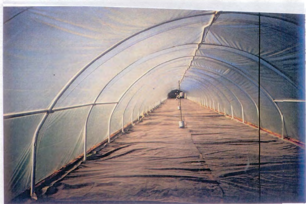
Bild E.8: Solare Holztrocknungsanlage mit natürlicher Konvektion: Blick in den Tunnelkollektor in Richtung auf die Trocknungskammer; in regelmäßigen Abständen Meßgeräte zur Bestimmung der Lufttemperatur
